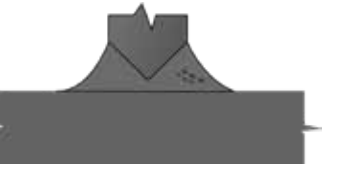
31 Porosity in Fillet (sub-surface) UT, RT
