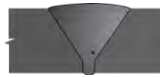
39 Porosity in Fillet (sub-surface) UT, RT
